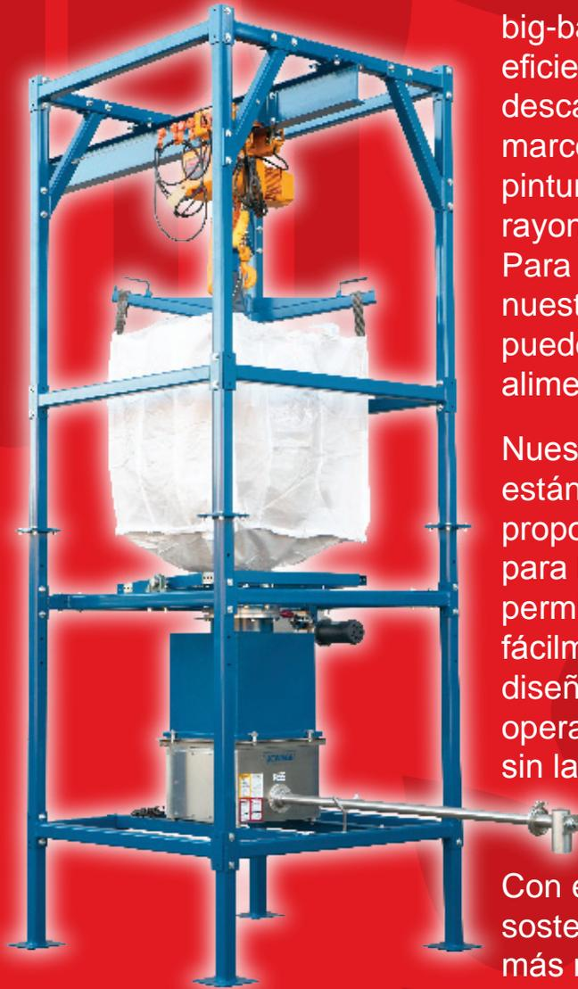
El descargador de big-bags de Tecweigh está diseñado para hacer el manejo de big-bags más fácil, rápido, seguro y eficiente (económicamente). Nuestro descargador se construye a partir de un marco robusto en acero soldado, con pintura electroestática resistente a rayones, a quebrarse y a la corrosión. Para un máximo rendimiento y comodidad, nuestros descargadores de big-bags pueden integrarse fácilmente con nuestros alimentadores volumétricos.
